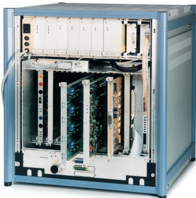
Stimulus- und Meßmodule werden an der Geräterückseite des TSA eingeschoben (Foto 38860)
