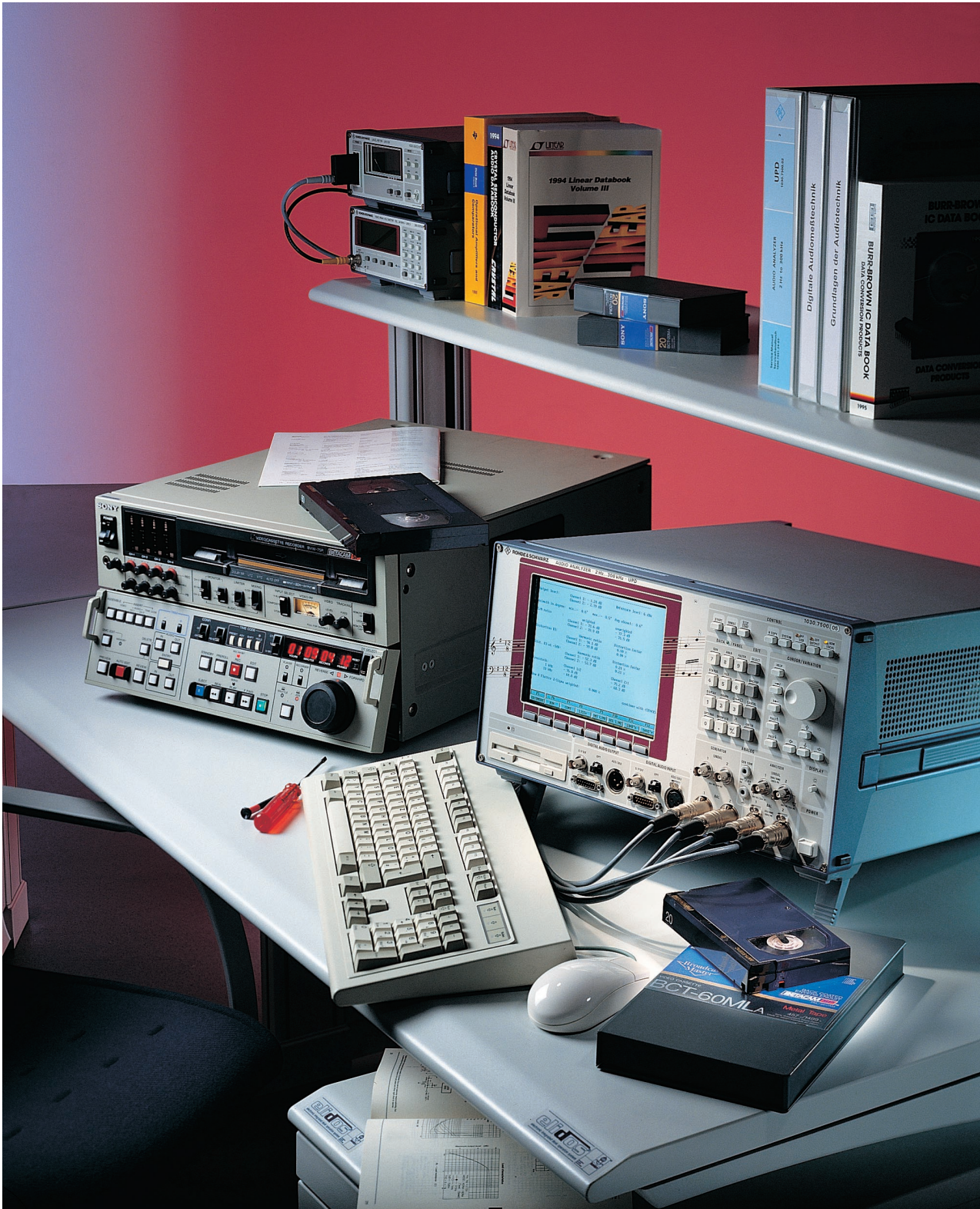
Schnelle und präzise Ermittlung sämtlicher Audioparameter an analogen und digitalen Schnittstellen: Audioanalysator UPD (Foto 42402)
