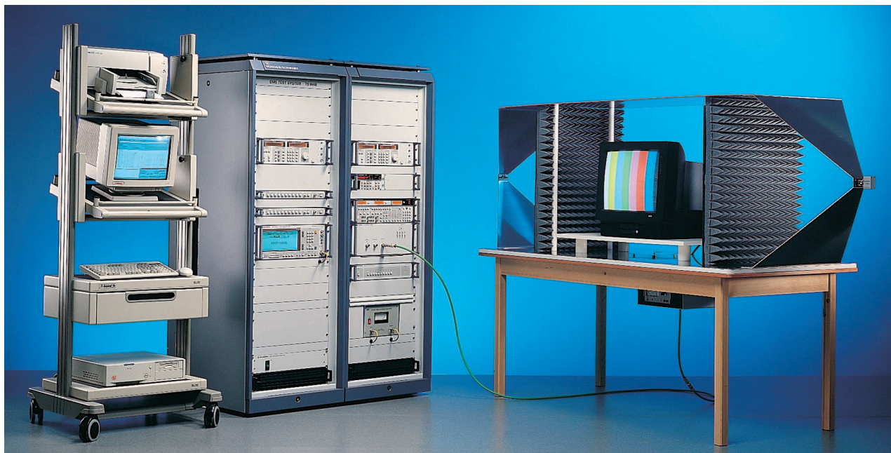
Störfestigkeitsmessung von Ton- und Fernseh-Rundfunkempfängern (Foto 42327-1)
