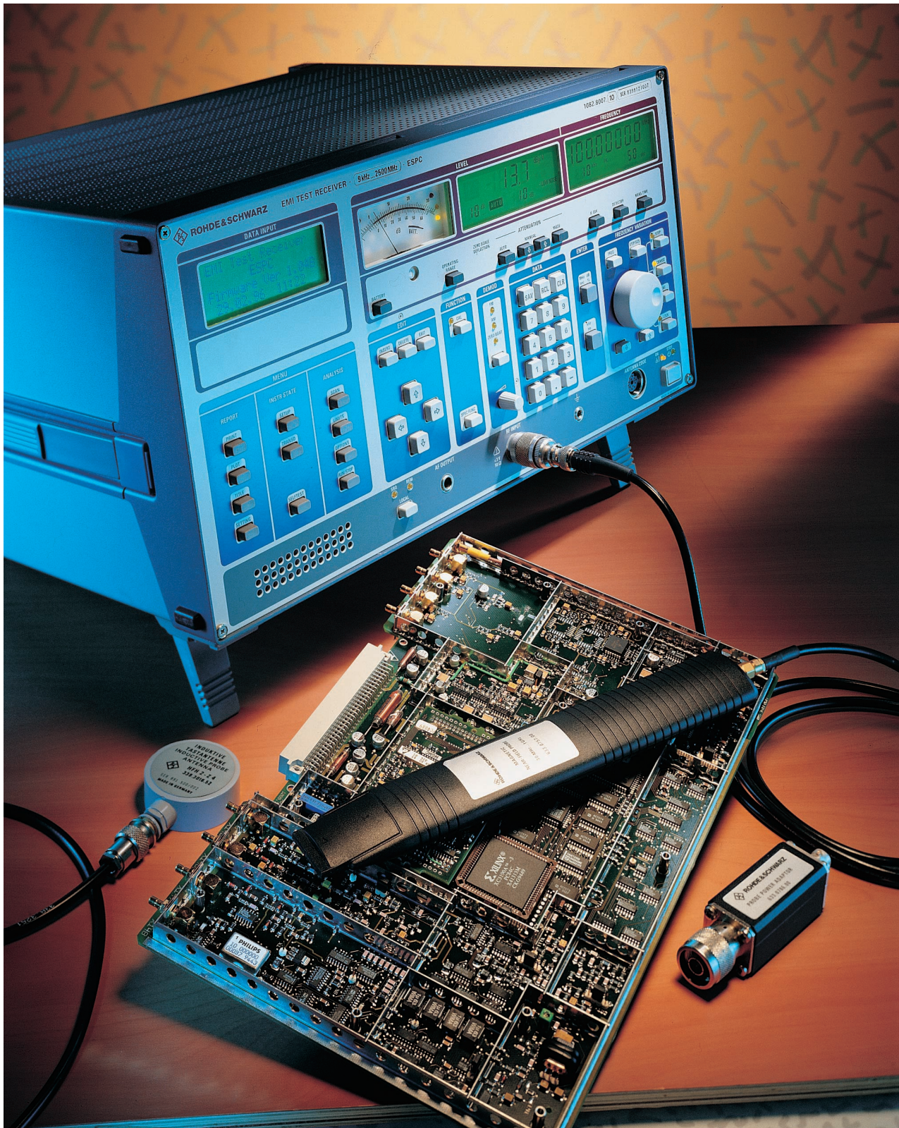
EMV-Precertification-Messung mit Meßempfänger ESPC und Nahfeldmeßsonde HZ-14 (Foto 42446-1)
